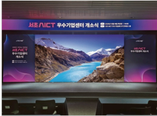
서초구청(양재시특구 우수기업센터 (10880x480mm, P2.5, 캐비닛 17개 ) (10240x3360mm, P2.5, 캐비닛 112개 )
